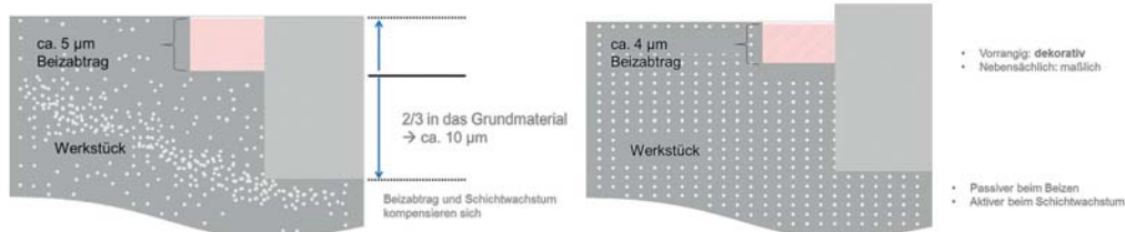
Abb. 8: Beizabtrag und Schichtaufbau beim Eloxierverfahren
