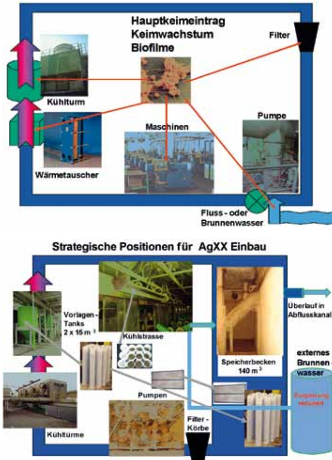
Abb. 5: Schematische Darstellung eines Prozesswasserkreislaufsystems mit charakteristischen Stellen für ein bevorzugtes Keimwachstum (oben); Darstellung von AgXX-Systemen in einem industriellen Prozesswasserkreislauf (unten)
